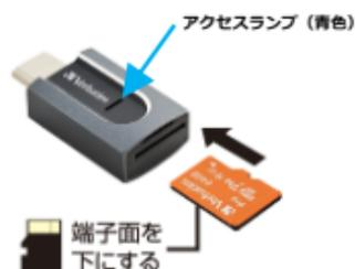
以下の写真のように、本製品の端面から約6～7mm程度、メモリーカードがはみ出る状態が正常です。
