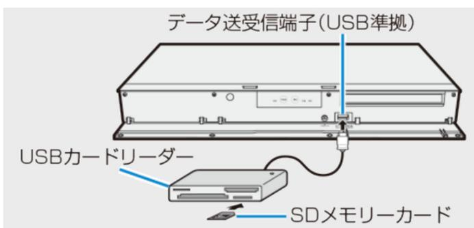
SD メモリーカードを USB カードリーダーに装着し、BD レコーダーのデータ送受信端子に USB ケーブルで接続します。
