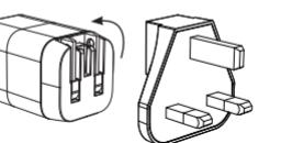
Cプラグ上部のコネクターを、本体のプラグをはさみ込むように上からかぶせ、カチッと音がするまで押し込みます。
