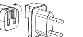
BFプラグ上部のコネクターを、本体のプラグをはさみ込むように上からかぶせ、カチッと音がするまで押し込みます。
